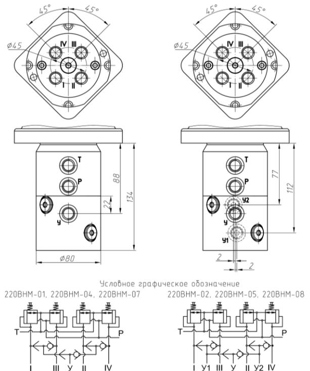
**Рисунок 2 - Блоки управления 220ВНМ-01, 220ВНМ-04, 220ВНМ-07 с блоком «ИЛИ» с одним отводом (остальное см. на рисунке 1)**
