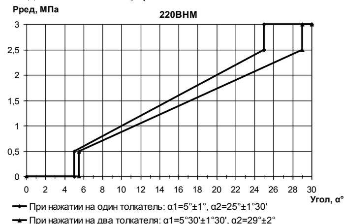
Рисунок 4 – Зависимость редуцированного давления от угла поворота
