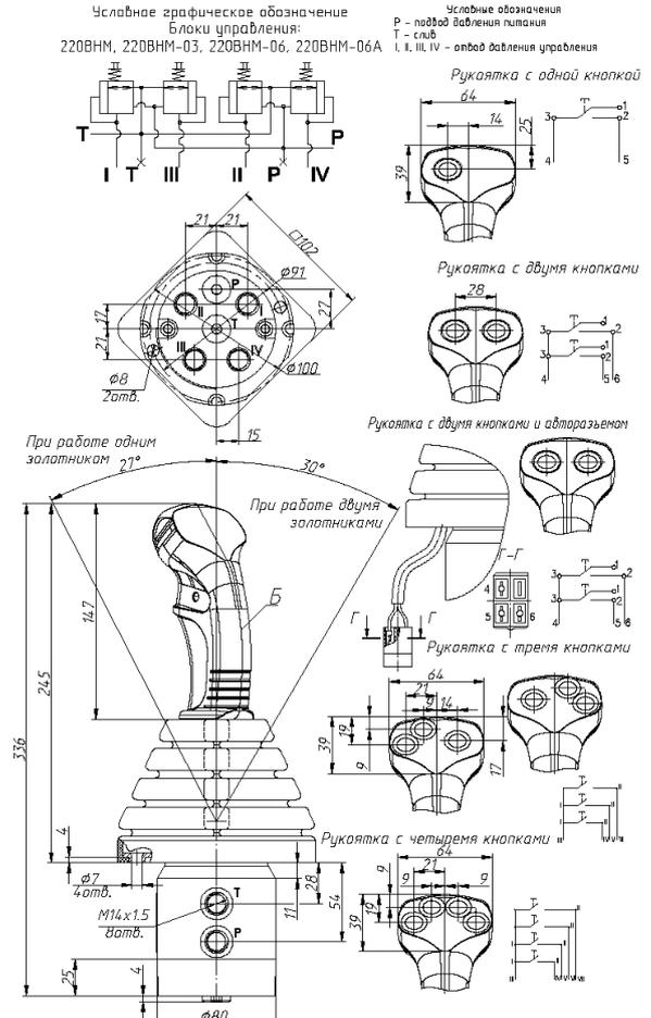
**Рисунок 1 - Блоки управления четырехзолотниковые с одной рукояткой серии 220ВНМ, варианты рукояток**
